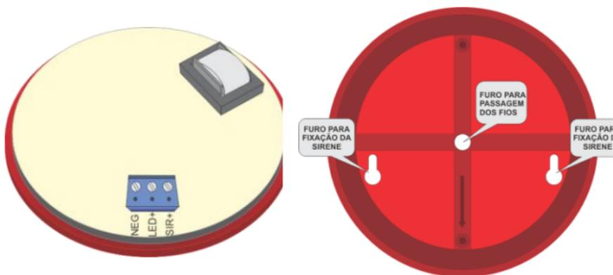
3. Prenda os fios da instalação nos bornes correspondentes. A sirene ALEXIS possui acionamento independente da sirene e dos LEDs, portanto há um borne negativo **NEG** comum aos dois acionamentos. Caso deseje acionar sempre os LEDs simultaneamente com a sirene, coloque um jumper entre o borne **SIR+** e o borne **LED+** e conecte o positivo (12V ou 24V conforme o modelo) em um dos bornes.
