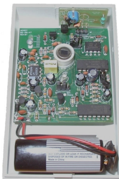
Colocação da bateria Figura 7
